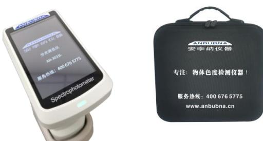
ANBUBNA Instrument 安享纳仪器 AN-3032LP 便携式分光测色仪，具有优秀的重复性和台间差，测量数据精准可靠。采用可见光全波段 LED 光源，配备了 2 种测量口径，满足各种大小、异型样品的测量。标配 QC 品质管理软件，支持连接电脑处理数据并自动生成质量报告。
