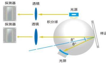
6, 10nm 分辨率光栅分光技术: 采用创新的 MEMS 工艺制作的光栅结合阵列传感器, 在 10nm 光谱分辨率基础上让色彩测量更精准。
