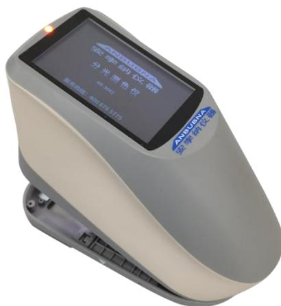
AN-3041 便携式分光测色仪采用符合 CIE No.15 的 45/0 (45 度环形照明, 0 度接收) 几何光学结构、凹面光栅分光方式，可精确测量样品反射率及各种色度数据。
