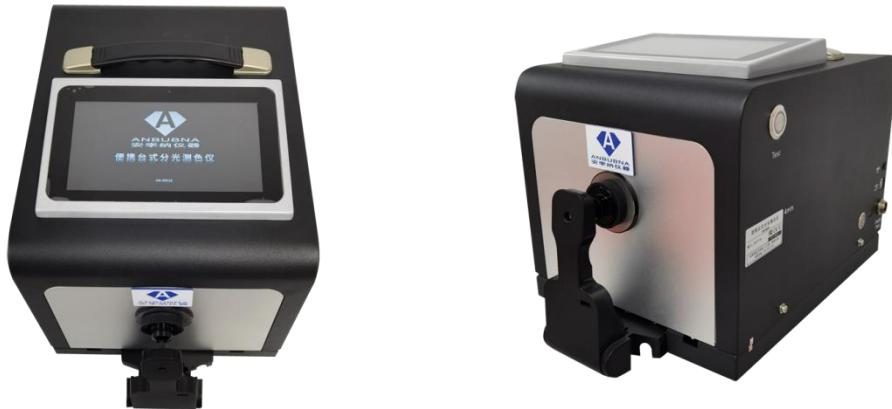
ANBUBNA Instrument 安享纳仪器 AN-3051S 台式分光测色仪，是一款运用自主光栅分光核心技术研发的分光测色仪。采用内置双列 40 组硅光电二极管阵列感应器、进口白板，同时兼顾测量速度与操作的便捷性，旋转按压式结构，测试更方便。重复性  $\Delta E^*ab$  最大值轻松控制在 0.04 以内，台间差  $\Delta E^*ab$  控制在 0.2 以内，测量精准，可用于实验室研究开发颜色的精确分析与数据传递。
