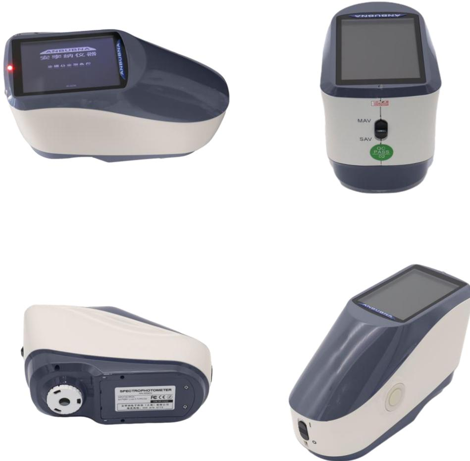
ANUBNA Instrument 安享纳仪器 AN-3032W 便携式分光测色仪，是一款运用自主光栅分光核心技术研发的分光测色仪。测量稳定、数据精确、功能强大。在 CIE 推荐的  $d/8^\circ$  几何光学照明条件下，AN-3032W 便携式分光测色仪可精确测量样品的 SCI、SCE 光谱反射率数据，在多种颜色空间下，能够对各种色差公式、颜色指数进行精准测量和表述。通过 AN-3032W 便携式分光测色仪，可轻松实现颜色数据的精确传递，可作为精准配色 iColorKey 配色软件系统的伴侣设备，在塑胶电子、油漆油墨、纺织服装印染、印刷纸品、汽车、医疗、化妆品和食品等行业，在大专院校、科研机构、实验室等领域的色差品质管控方面有着广泛的应用。AN-3032W 便携式分光测色仪标配 QC 品质管理软件，连接电脑使用，实现更多功能扩展。
